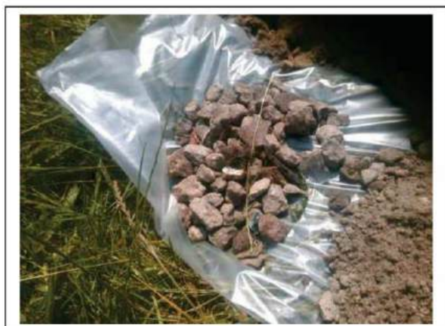
Foto 1. Opgegraven en gezeefd materiaal inspectiegat 06A
