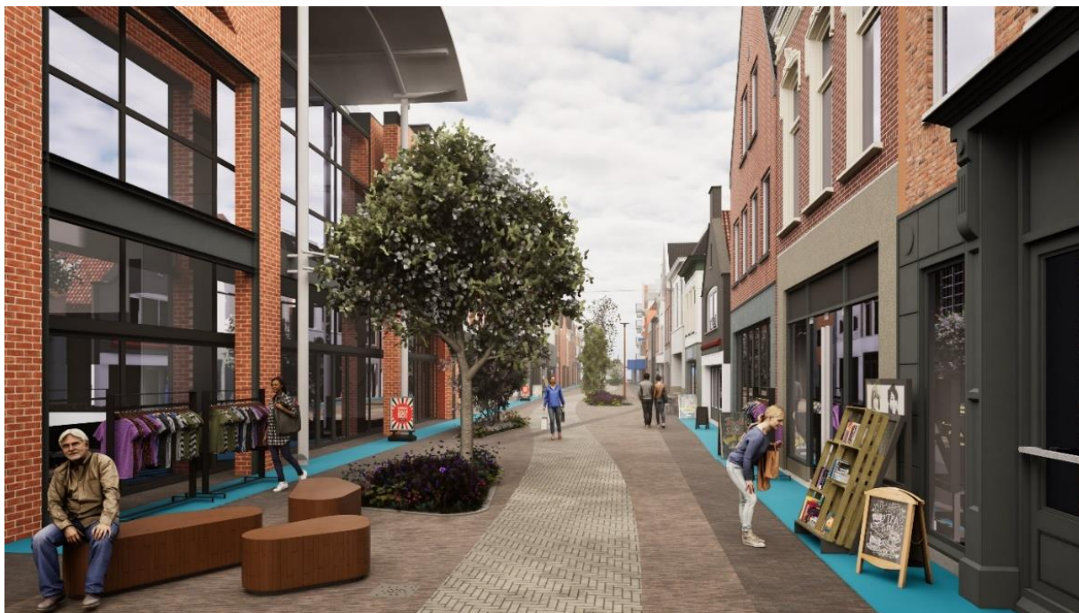
Figuur 1: de uitstallingszone is in het blauw aangegeven. De uitstallingen aan de rechterkant van de straat leiden niet tot een beperking van de doorgang van 1,5 meter. Uitstallingen aan de linkerkant ter hoogte van het bankje met de zittende voetganger doen dat mogelijk wel. In dat geval moet de uitstalling hier zodanig geplaatst worden dat de 1,5 meter doorgang gewaarborgd blijft.
